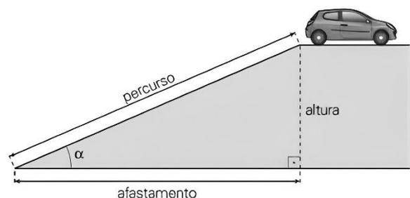
Sabendo que  $\alpha = 60^\circ$  e a altura da rampa igual a 2,5 metros, então o comprimento da rampa é:
